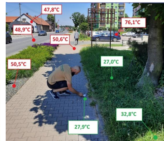
Mesure de température de surface sur différents substrats à Tcheque Dziedzice (Pologne) avec une température de l'air de 28,5° - Source : DR
